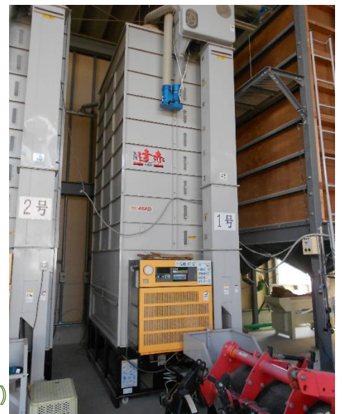
りゅうけいせんべつき 粒径選別機 (草の実や虫くいを取り除き、大豆の粒を大・中・小に分ける)
